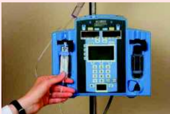
ETAPA 9a Inserir o equipo IV na câmara do mecanismo de controle.
