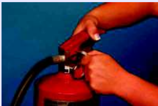
ETAPA 10e (1) (a) Remover o pino de segurança de extintor de incêndio.
