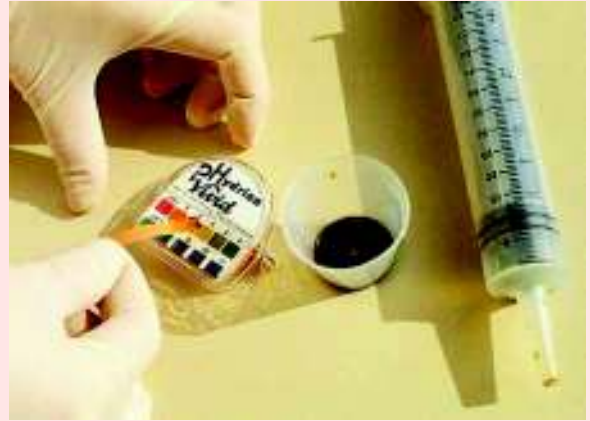
ETAPA 2f Comparar a cor na faixa de teste com a cor do gráfico de pH.
