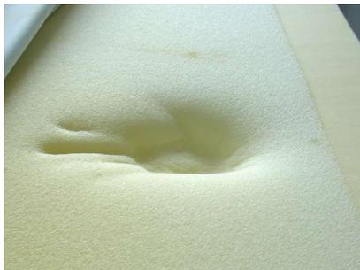
**Figura 13** - SA estática - Colchão de base de espuma de poliuretano viscoelástico
